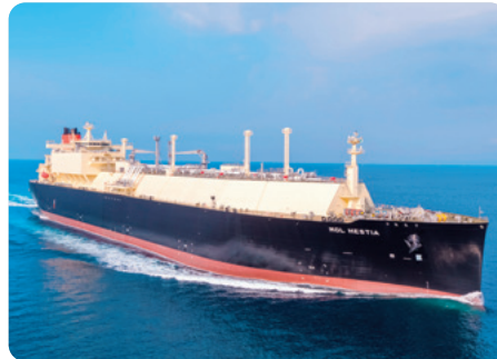
Membrane-type LNG carrier
